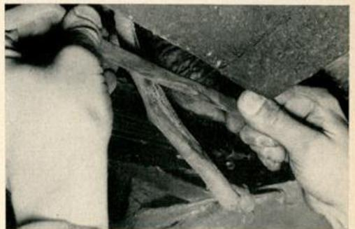
Bremsschläuche und Batteriekabel gegenseitig durchgescheuert
