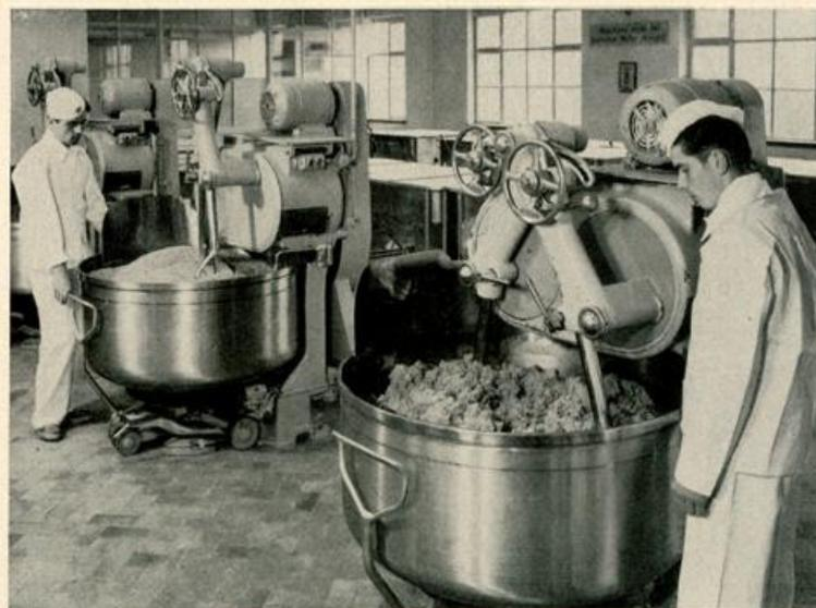
▲ In modernen Rührwerken und Mischmaschinen werden der Suppenmasse nach sorgfältig erprobten Spezialrezepten getrocknete Gemüse, Gewürze, Fett und das den pikanten Geschmack hervorhebende Glutamat beigemischt.
