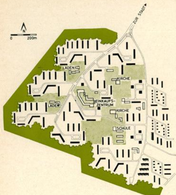
Abb. 11: Oberreit — Das Straßennetz wird von einem Fußwegenetz überlagert, das in direkter Verbindung zu dem die Siedlung umgebenden Wald steht. In diesem Fußwegenetz liegen die Läden, Schulen, Kirchen und Sportanlagen.
