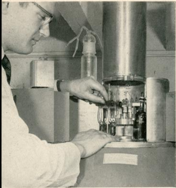
Einsetzen von Bestrahlungsproben in eine Kobaltquelle
